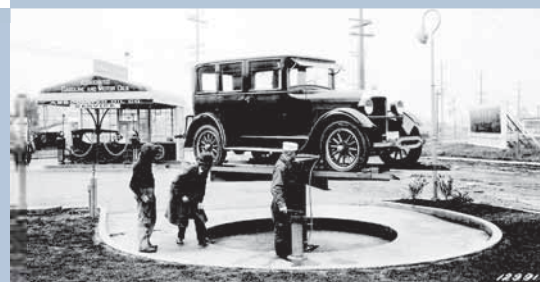
Rotatable En av de första billyftarna från Rotary Lift
